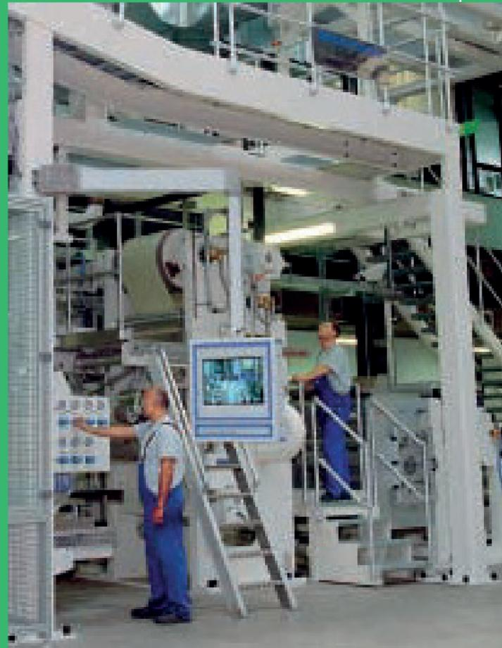
Kaschier- und Aufwickelbereich der neuen Beschichtungsanlage für wässrige Haftklebstoffe archivieren.
